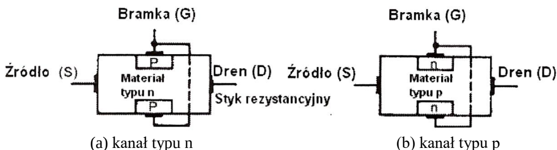
Rys. 8-1-1 Budowa tranzystora polowego JFET
